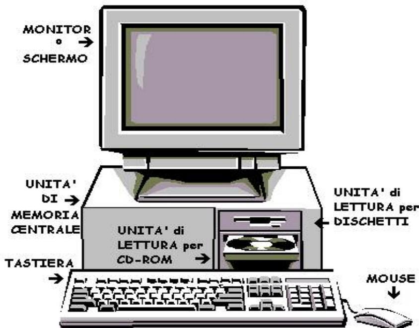
Tramite la tastiera ed il mouse inseriamo nel PC i nostri dati.
