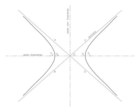
L'iperbole è formata da due rami simmetrici rispetto ad una coppia di assi ortogonali, detti **asse traverso** quello passante per i due fuochi, **asse non traverso** l'atro. L'asse traverso interseca i due rami della curva nei **vertici**. Due rette tangenti alla curva all'infinito sono detti **asintoti** e rappresentano le due generatrici della superficie conica che si ottengono sezionandola con un piano contenente l'asse del cono parallelo a quello che genera l'iperbole.
