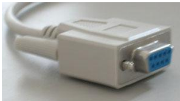
Esempio di cavo seriale 9pin
