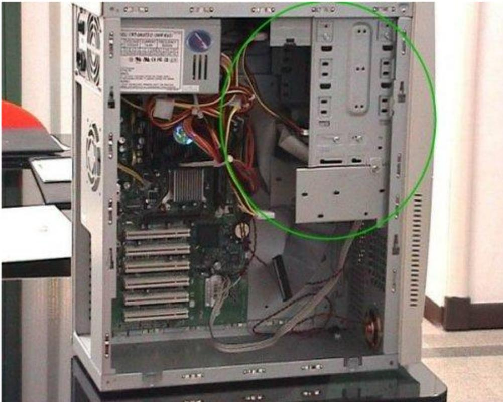
Nel scegliere la posizione per installare il disco fisso, è bene tenere in considerazione anche che il disco, durante il funzionamento, si scalda molto. È quindi importante non installare vicini troppi dispositivi che possono avere problematiche simili ma, anzi, lasciare spazio libero attorno al disco per permetterne una buona ventilazione interna.
