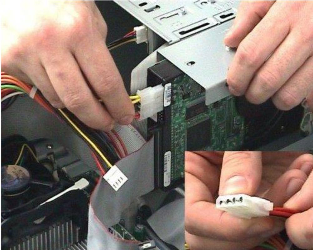
Inseriamo ora il connettore d'alimentazione; anche in questo caso il connettore ha un senso obbligato e uno standard di colori. Il filo rosso del cavo di alimentazione va verso il centro del disco, quindi verso il cavo dati. A questo punto il disco è montato e collegato, non rimane altro che chiudere il computer, alimentarlo e procedere alla configurazione del BIOS.
