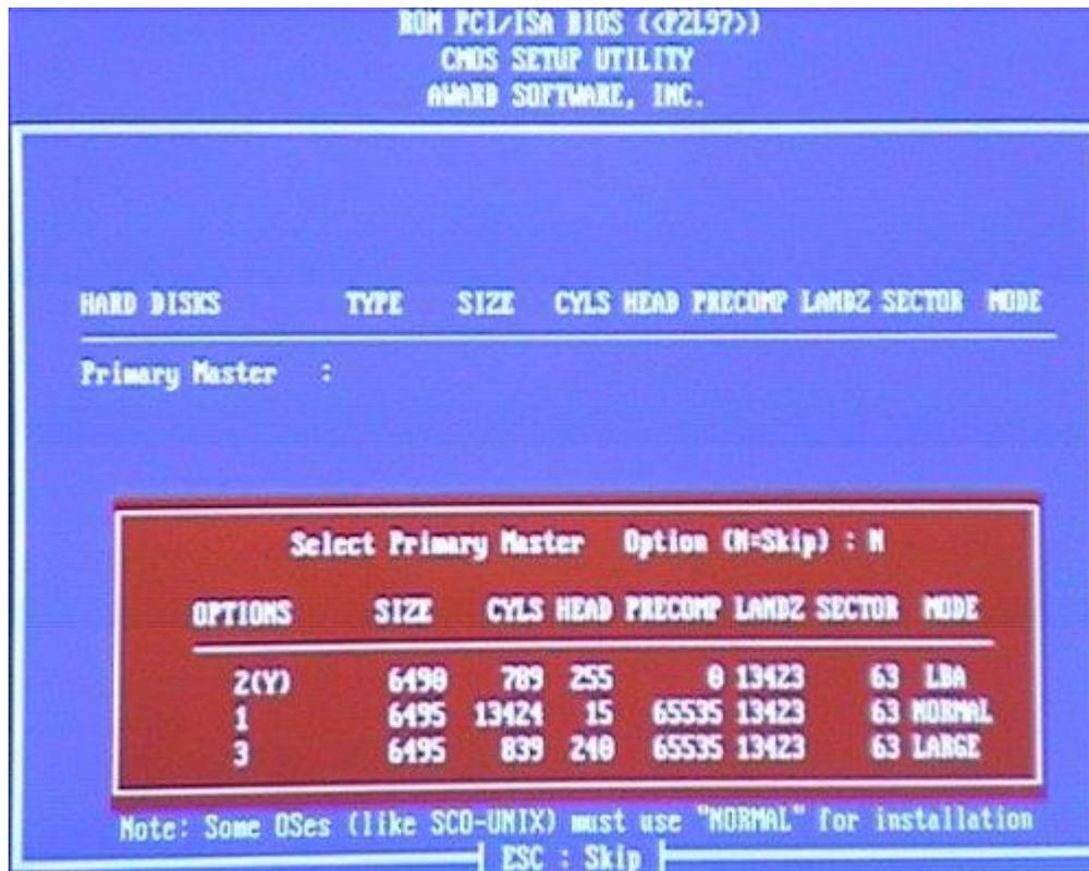
Esiste comunque anche in questo BIOS la possibilità di utilizzare un programma di autoconfigurazione: il programma verificherà, per ogni possibilità, l'esistenza di un dispositivo e proporrà alternative per la configurazione del dispositivo riconosciuto.
