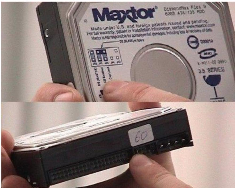
Le altre possibili configurazioni sono per un disco slave o per un disco keyboard select. Quest'ultimo caso è di solito il più utilizzato: permette al controller IDE di capire automaticamente l'uso del disco, quindi se il disco viene usato in modalità master.
